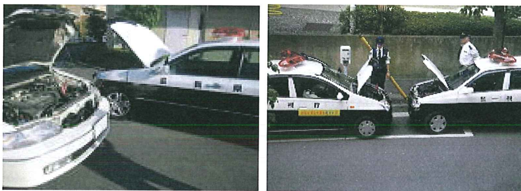
図 4-25 バッテリー上がり時の応急対応の事例
